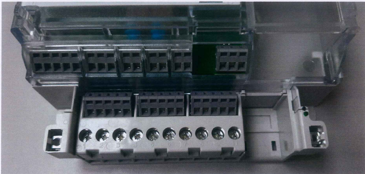
Fotografía 4. Vista superior de los bornes del medidor evaluado
